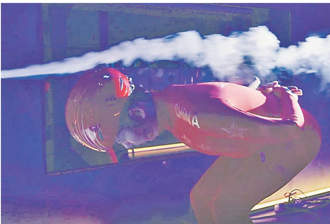
安踏為中國短道速滑隊設計的專業比賽服進行風洞測試。(資料圖片)
